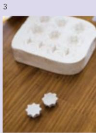
石膏型から取り出し3日ほど乾燥させた直後が右側。その後ヤスリで磨き上げると左手前のような美しい星形になります。
